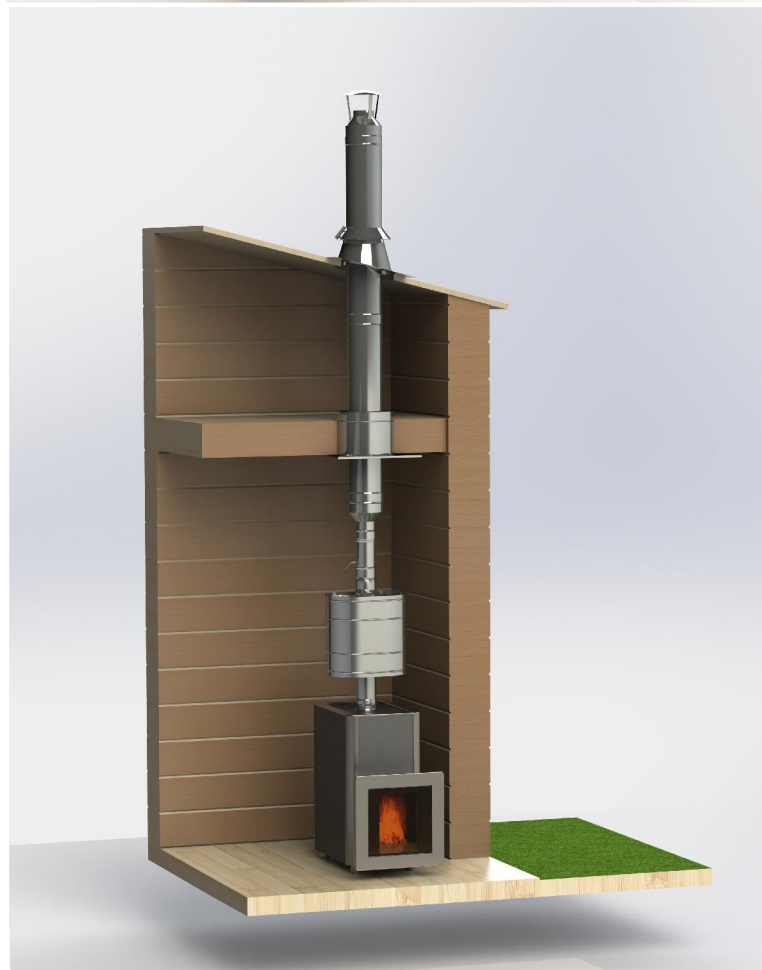
Рис.11 Способ монтажа дымохода с использованием шибер-здвижки и «Декоративным ППУ 3 детали»
